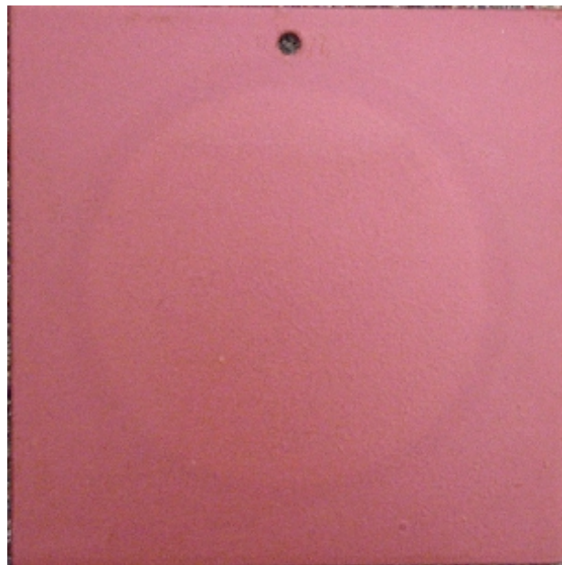
~12 mil Teflon ® 532-13054 over primer unaffected except for slight color shift
